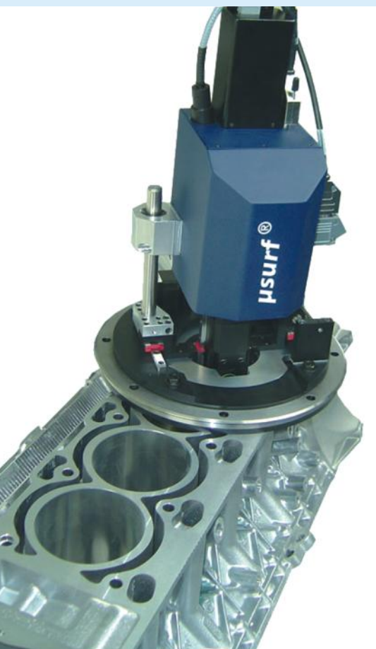
Inspektion der Zylinderlauffläche eines Hochleistungsmotors mit dem NanoFocus µsurf® Analysing the cylinder surface of a high-performance engine using the NanoFocus µsurf®
